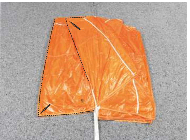
18. Bahn 6 legen und den oberen Teil der Bahn 5 seitlich herausziehen (Evo Cross 160: Bahn 7, oberer Teil der Bahn 6; Evo Cross 235: Bahn 9, oberer Teil der Bahn 8).
