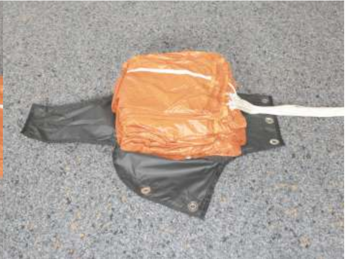
28b. Den Rest der Kappe auf in S-Schlägen aufeinander legen (stack-pack).
