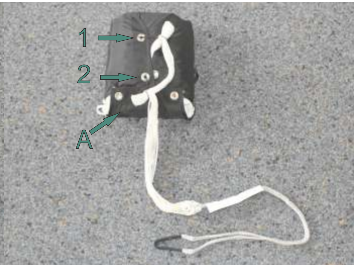
30b. Innencontainer mit den Fangleinen verschließen. Zuerst die lange Seite (Nr. 1). Nr. 2) wird zusammen mit der mittleren Öse des verbleibenden Containerlappens A geschlossen.
