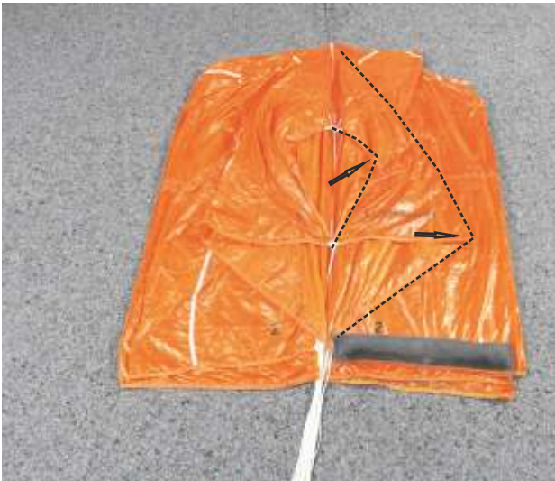
13. Bahn 1 legen (Eckbahn) und Basis mit Gewicht beschweren.
