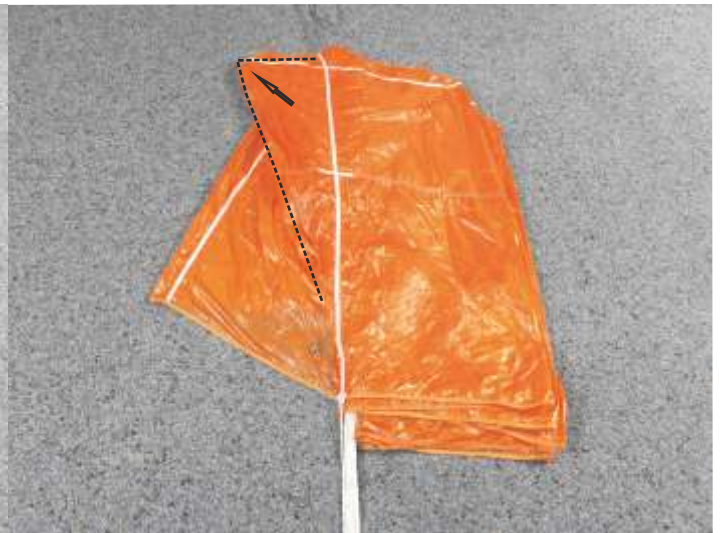
16. Oberer Teil der Bahn 8 (Evo Cross 160: Bahn 10; Evo Cross 235: Bahn 14) zur Seite rausziehen.
