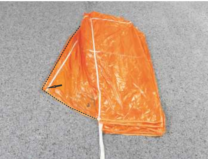
15. Bahn 9 (Evo Cross 160: Bahn 11; Evo Cross 235: Bahn 15) mittig zum Boden legen und die Bahn 8 (Evo Cross 160: Bahn 10; Evo Cross 235: Bahn 14) zur Seite rausziehen.
