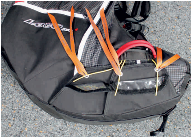
7. Die vordere Containerklappe schließen und mit den Kabeln sichern.
