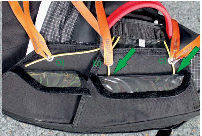
8. Das überstehende Kabel von b) und c) in die Aufnahme in der Containerklappe stecken.
